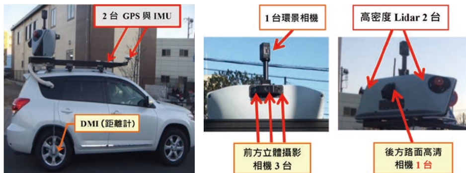
圖 1 MMS (Mobile Mapping System) 車設備 (以日本國際航業設備為例)
