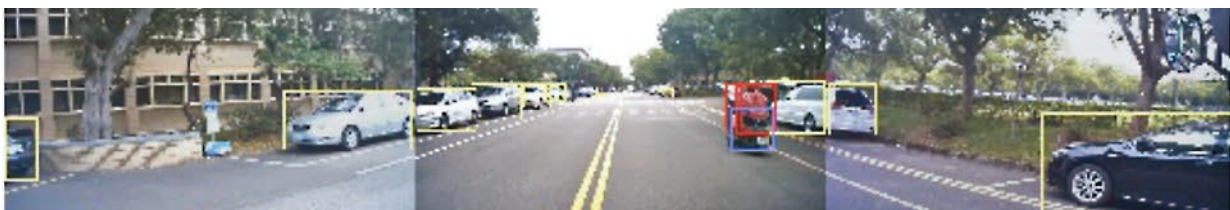
圖 9 自駕車前方相機物件偵測
