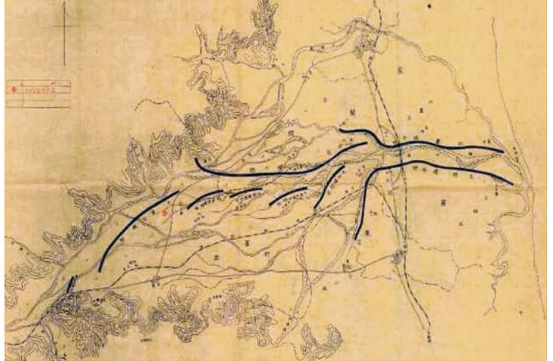
圖 12 具有霞堤系統形式的宜蘭濁水溪治水工事平面圖
