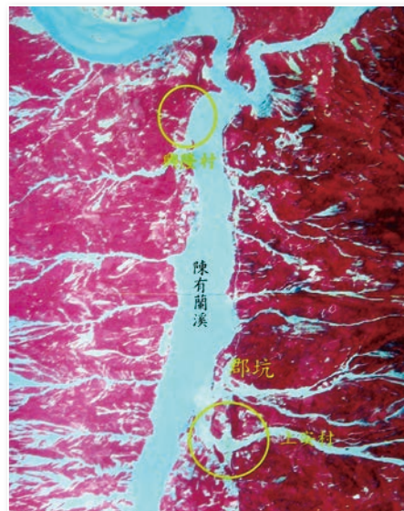
圖 26 陳有蘭溪桃芝颱風在豪雨災後, 溪谷擴張變寬, 兩岸土石流坑溝密佈 (農委會提供空載多譜掃瞄影像)
