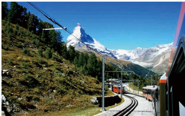
圖 13 瑞士在阿爾卑斯山區採用電氣化鐵路（加鐵鍊拉力），用地小，污染少（倪勝火教授攝）
