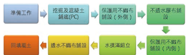
圖 11 雨水貯留設施 (雨撲滿) 施工流程圖
