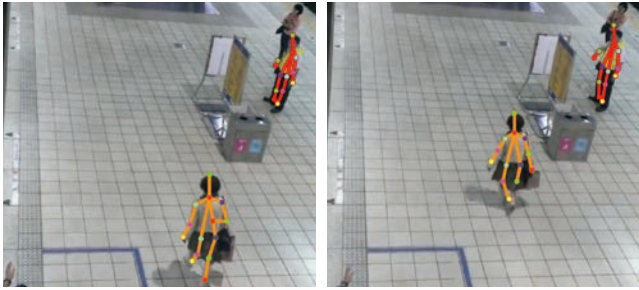
圖 4 PoseTrack 於臺北市捷運站月台內側錄影像辨識與追蹤之成果
