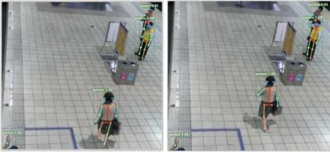
圖 2 Mask R-CNN 辨識成果 — 臺北市捷運站月台內側錄之影像
