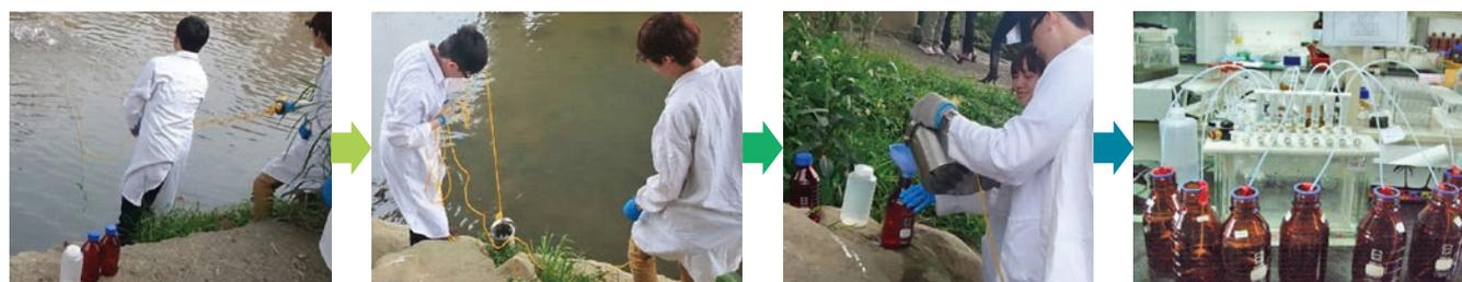
圖 1 現場取樣及水體樣品前處理流程
