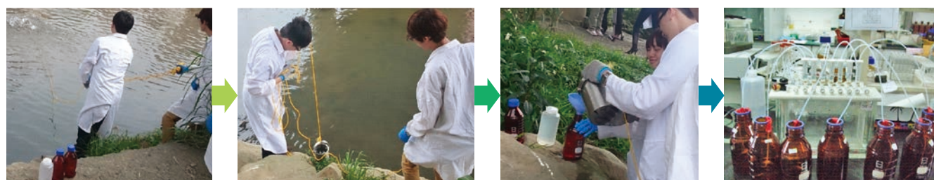
圖 1 現場取樣及水體樣品前處理流程
