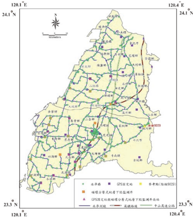
圖 4 濁水溪沖積扇監測點位分佈圖。圖中綠色圓點為水準樁，紫色、橘色與黃色方形分別為 GPS 固定站、地陷監測井與水準測量參考點，桃紅色三角形為 GPS 與地陷監測井共站處，藍色實線為水準測線，紅白線段為高鐵路線，綠色空心線為中山高速公路。
