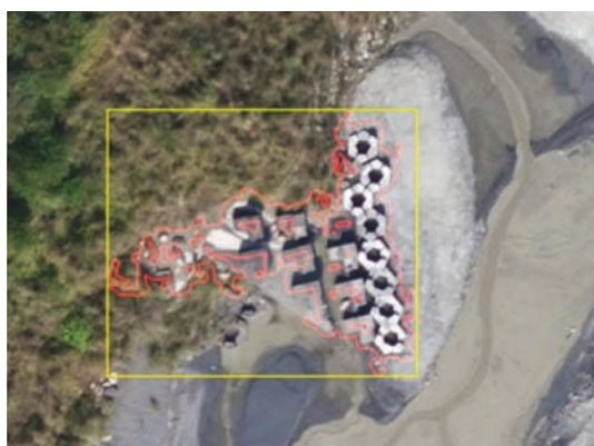
圖 18 半自動化基腳保護工區域偵測成果
