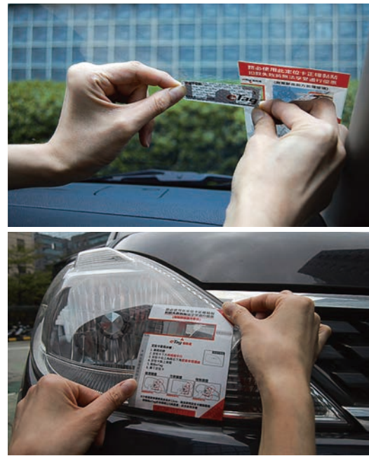
圖 9 車窗型 eTag 與車燈型 eTag
