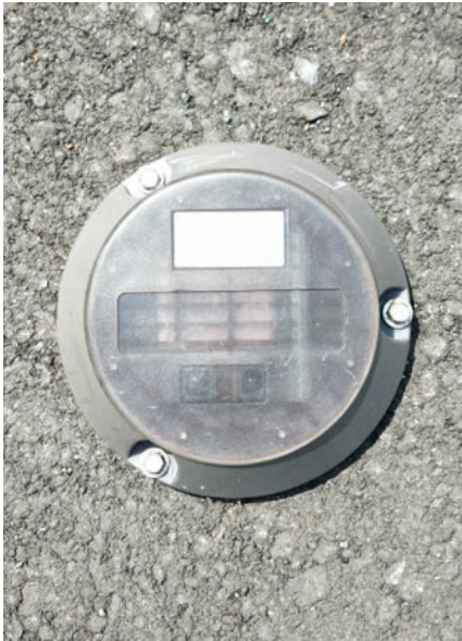
圖3 智慧停車場的在席偵測系統——地磁 資料來源：台灣國際開發事業有限公司
