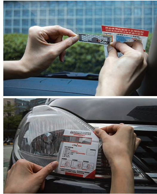
圖 9 車窗型 eTag 與車燈型 eTag
