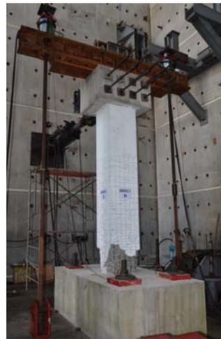
圖 9 RC 柱實驗配置
