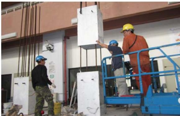
圖 7 NEWRCH3 節塊吊放製作
