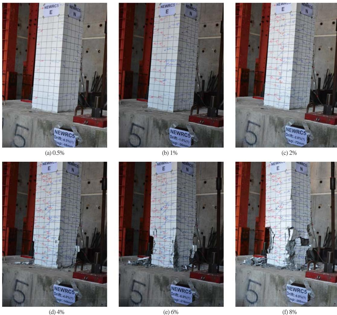
圖 14 NEWRC5 試體裂縫發展與損壞過程
