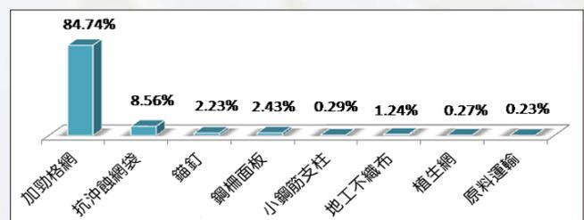
圖 7 原料階段建材之溫室氣體排放量比例
