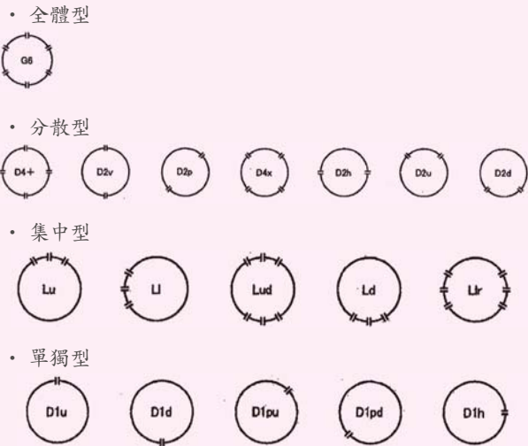
圖 11 既有管線損傷型態之分類 (一)
