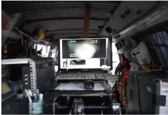
圖 8 CCTV 檢視車內部
