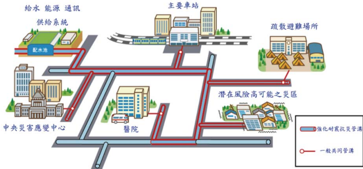
圖 14 地下維生管線之未來管理方向 — 強化重要設施供給系統 [3]
