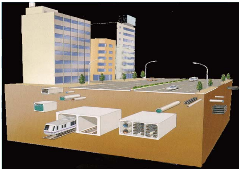
圖 1 複雜之都市地下維生管線系統 [4] (1 km 長的道路約有 36 km 長的地下設施)
