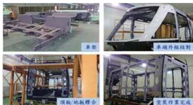
圖 14 列車組裝作業照片
