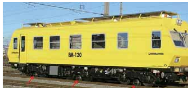
圖 1 EM120 軌道線形檢測車的接觸式軌道線形檢測設備（紅色箭頭指示處）
