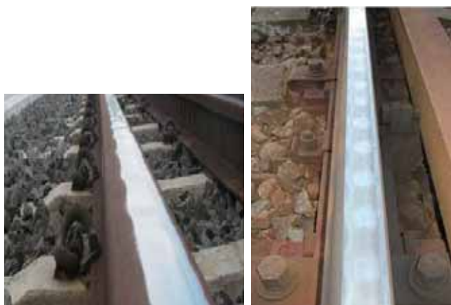
圖 4 鋼軌的波狀磨耗 [5,6]
