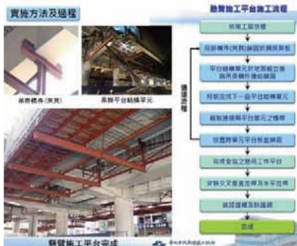
圖 15 懸臂施工平台施作流程
