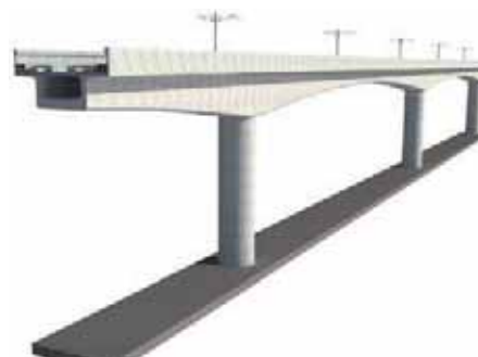
圖 21 非制式橋—連續預力箱型梁橋透視圖
