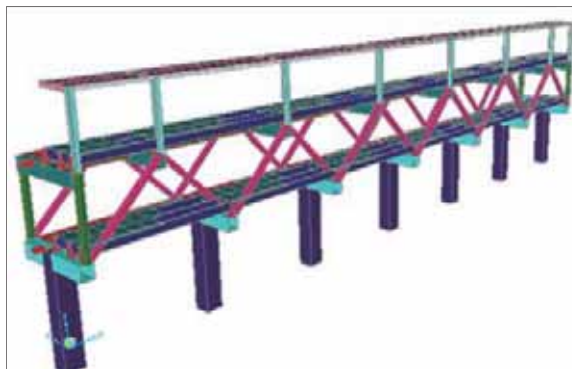
圖 7 疊式月台高架車站結構透視圖及照片
