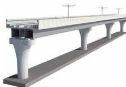
圖 20 非制式橋—鋼箱型梁橋透視圖
