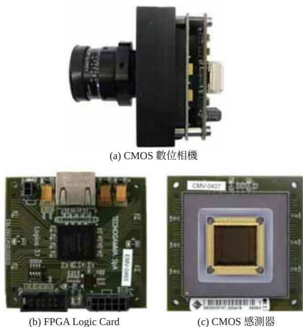
圖 7 CMOS 數位相機的組成
