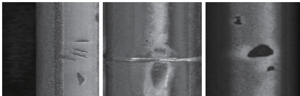
圖 26 軌頭檢測系統 (THIS) 擷取的典型圖像
