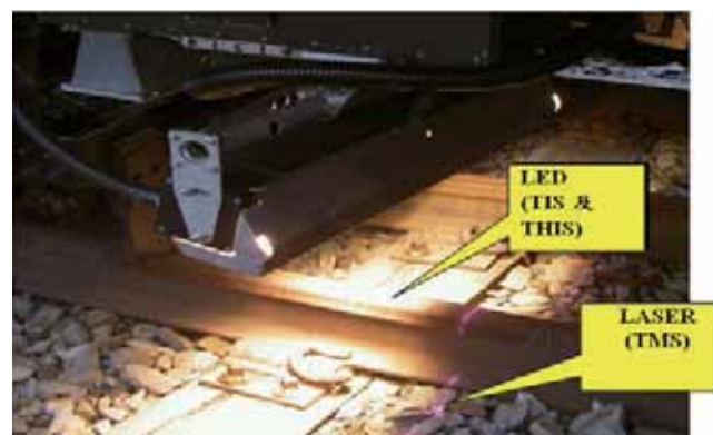
圖 20 V-CUBE 檢測系統的 IR 紅外光光源 (LED 及 LASER)
