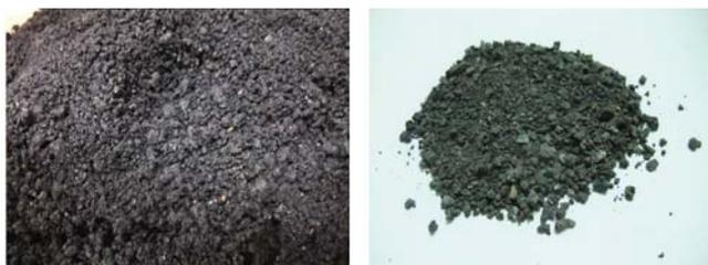
電弧爐氧化渣（細粒料） 電弧爐氧化渣（細粒料）
