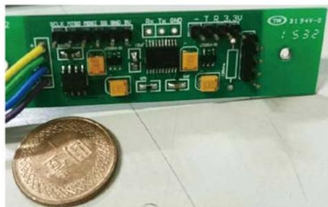
圖 6 智慧節點（smart node）其尺寸為 74 × 19 mm
