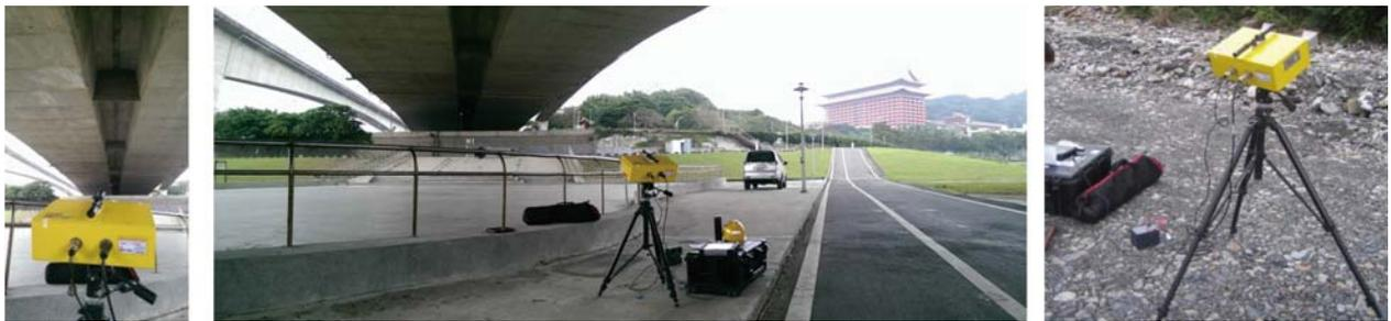
圖 1 遠距微波動態位移測量儀
