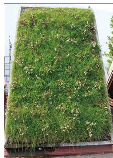
圖 27 多孔隙混凝土版植草試驗 → (洪如江攝於日本竹中工務店研究中心)
