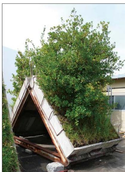
圖 28 多孔隙混凝土版植生小灌木試驗 (洪如江攝於日本竹中工務店研究中心)
