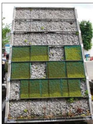
圖 26 多孔隙混凝土版的植生試驗 → (洪如江攝於日本竹中工務店研究中心)
