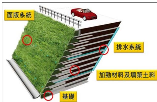
圖 23 加勁結構配置示意圖 (盟鑫公司提供)
