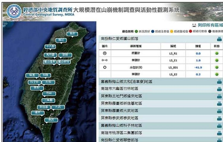
圖 4 地調所大規模崩塌觀測系統介面
