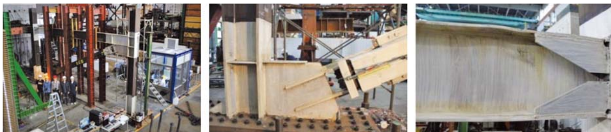
圖8 一層樓 DC-SCBF 在層間側位移角2%之實驗情形（第3階段試驗）
