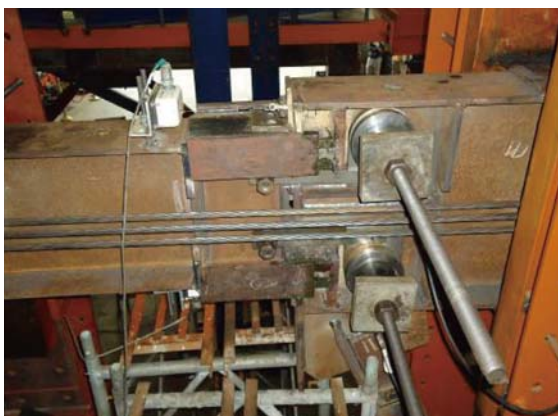
圖 2 摩擦鉸消能阻尼器設計圖與照片
