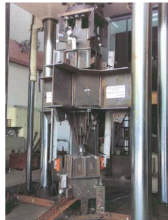
(a) 實尺寸鋼棒接頭組試驗照片
