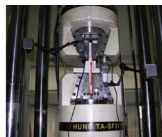
(e) 十字試體單軸反覆載重實驗
