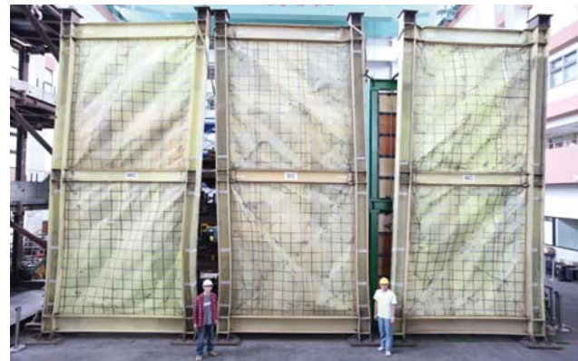
圖 18 三座試體試驗後並排景象
