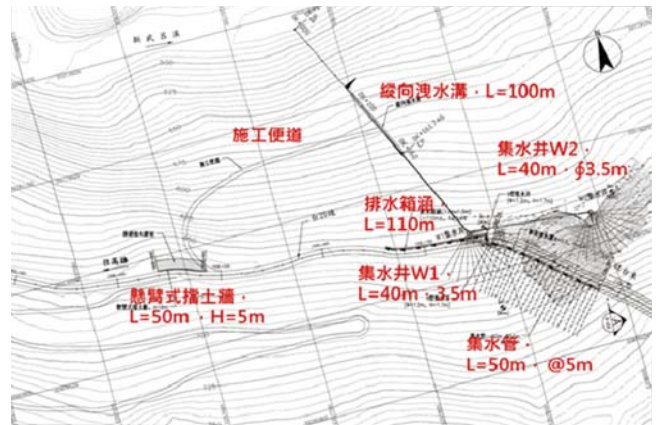
圖 21 邊坡整治排水工法設置
