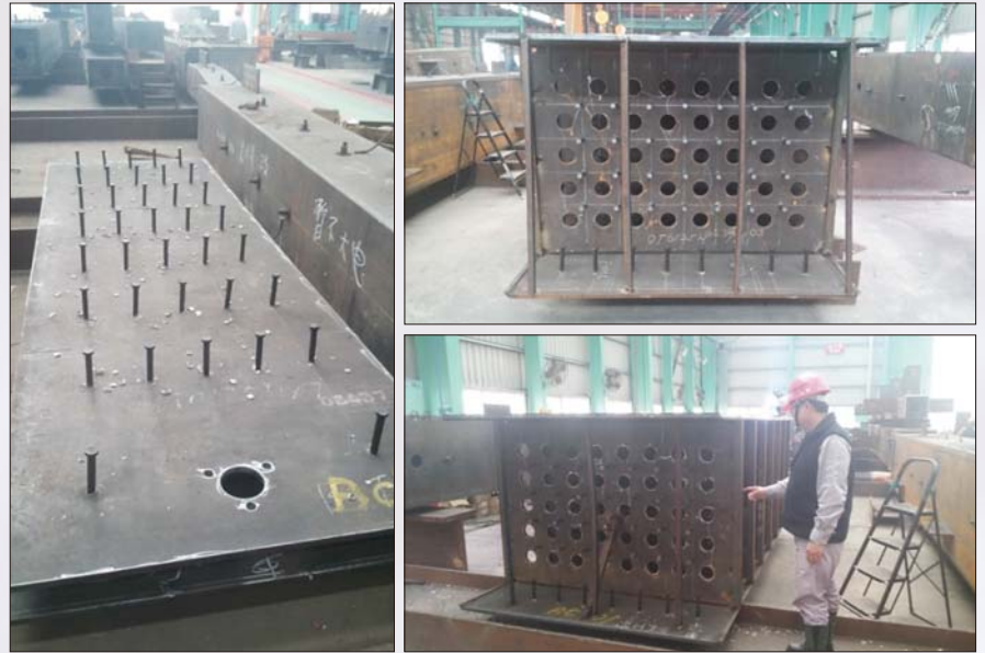
圖 10 第三階段灌漿模具之製造
