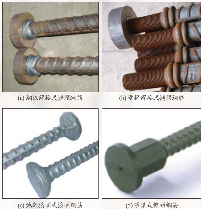
圖 3 常用擴頭鋼筋種類
