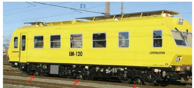
圖 1 EM120 軌道線形檢測車的接觸式軌道線形檢測設備（紅色箭頭指示處）
