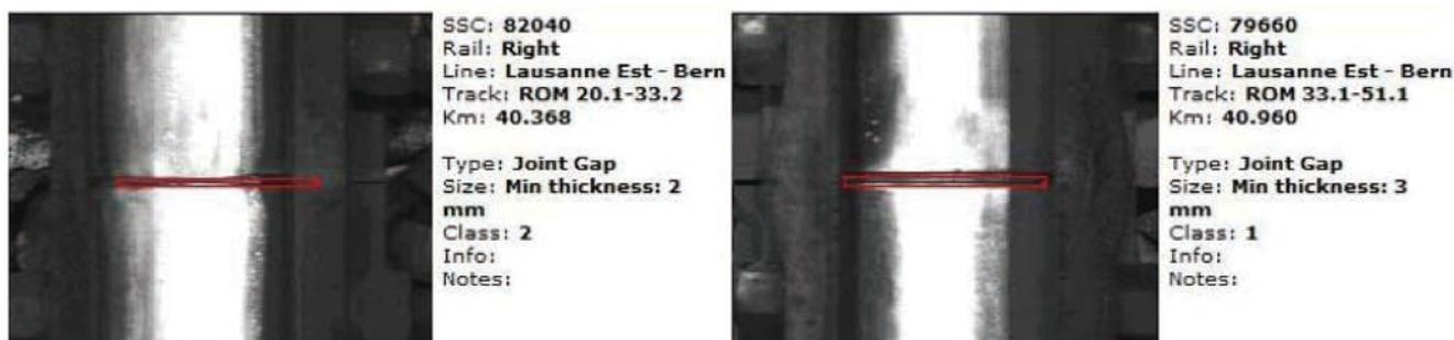
圖 29 絕緣墊片處的檢測報告文件
