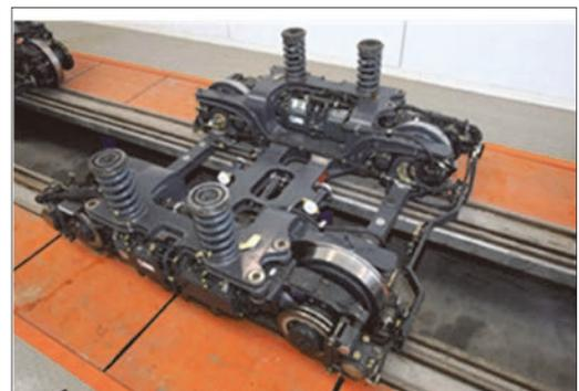
圖 5 高雄輕軌第一階段車輛轉向架外觀圖
