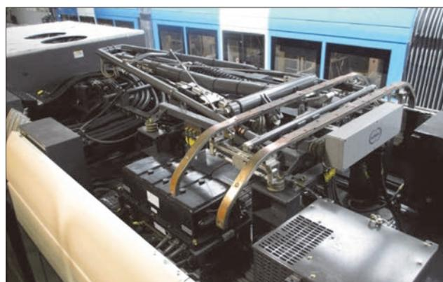
圖 7 高雄輕軌第一階段車輛集電弓
