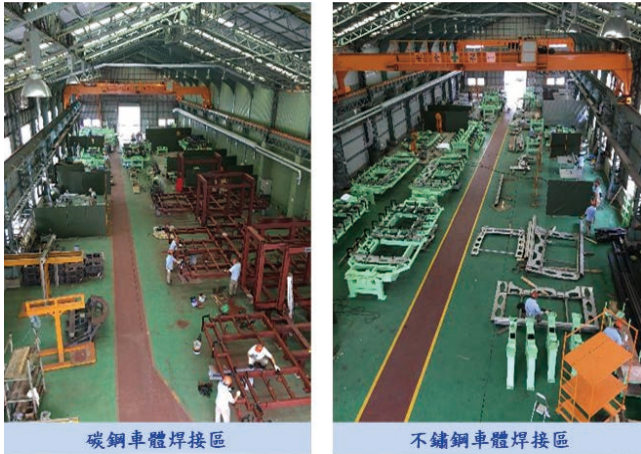
圖 13 車體焊接廠區照片
