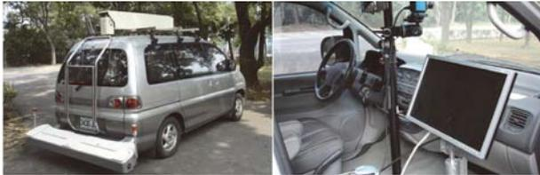
圖 2 鋪面影像檢測車示意圖 (以中央大學土木工程系開發為例)
