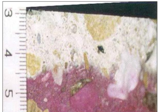
圖 2 混凝土層碳化部分經酚酞滴定成粉色
