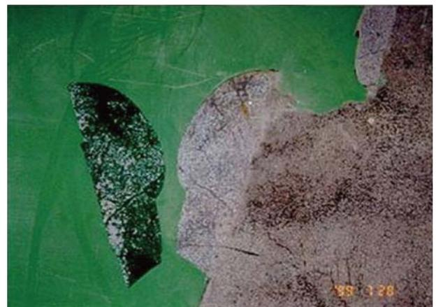
圖 12 混凝土塗裝缺陷—剝離
