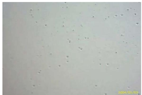
圖 3 混凝土塗裝缺陷—氣孔
