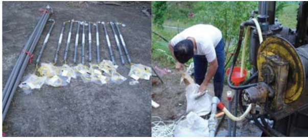
(a) PVC 管封裝 (b) 特密管封層 圖 12 FBG 水壓計串列封裝與現場安裝
