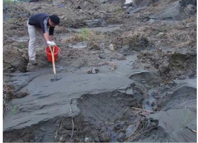
圖 25 2月15日於曾文溪堤岸側潰處進行液化土砂取樣 (楊炫智提供)
