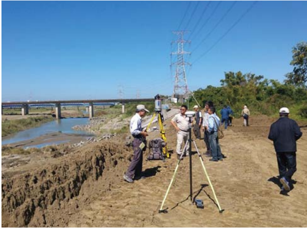
圖 23 協力廠商於日新堤岸側潰處進行數位地形掃描測繪 (許尚逸提供)
