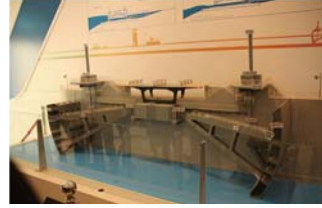
圖 15 新萬金防潮堤閘門縮尺模型
