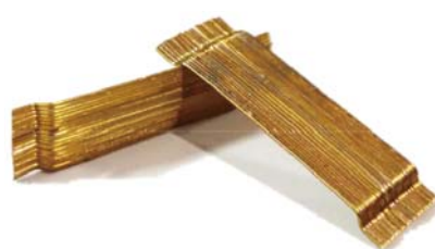
圖 2 Dramix RC-80/30-BP 圓形斷面端鉤型鋼纖維
