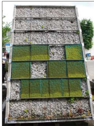
圖 27 多孔隙混凝土版植草試驗 →（洪如江攝於日本竹中工務店研究中心）
