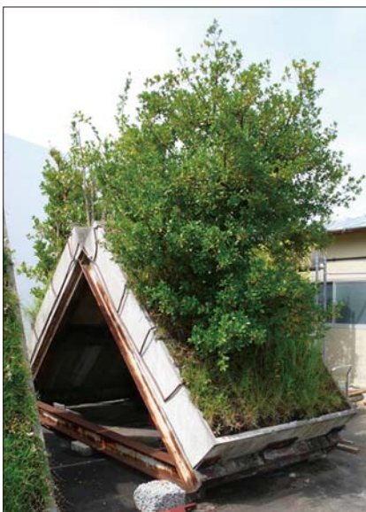
圖 28 多孔隙混凝土版植生小灌木試驗（洪如江攝於日本竹中工務店研究中心）
