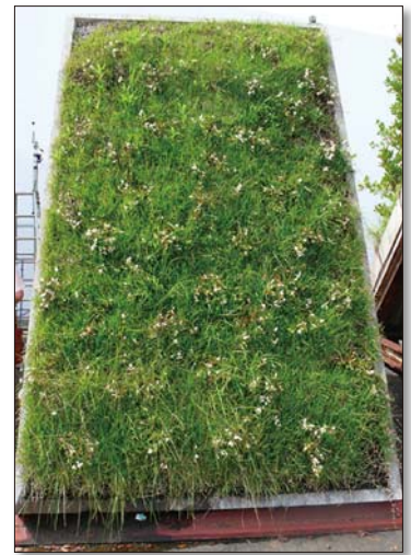
圖 27 多孔隙混凝土版植草試驗 →（洪如江攝於日本竹中工務店研究中心）
