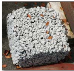
圖 25 多孔隙混凝土作為植生之基材（洪如江攝於日本竹中工務店研究中心）
