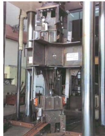
(a) 實尺寸鋼棒接頭組試驗照片
