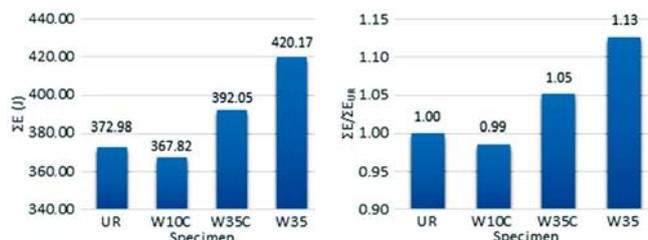
圖 9 各試體累積消能容量比較圖
