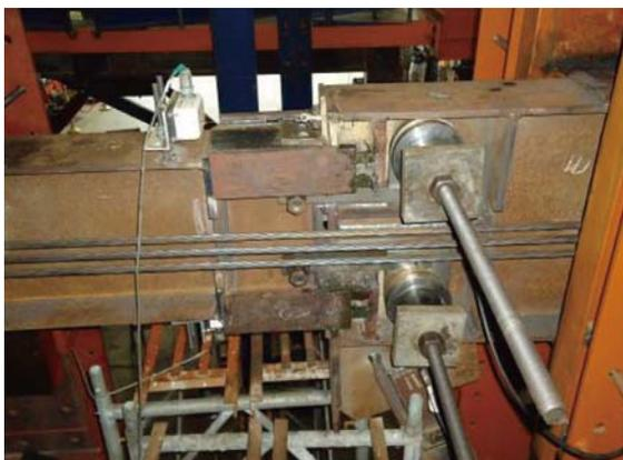
圖 2 摩擦鉸消能阻尼器設計圖與照片
