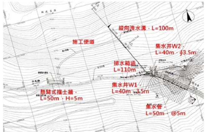
圖 21 邊坡整治排水工法設置
