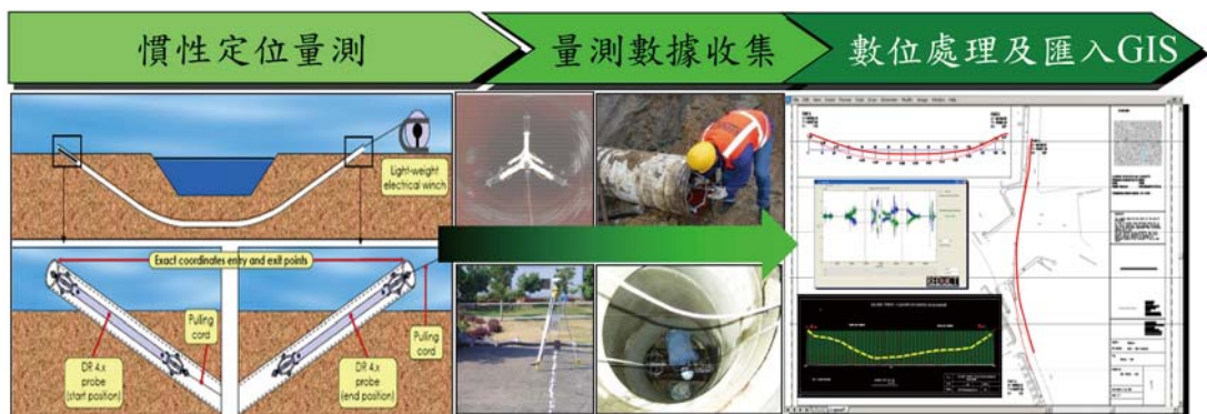
圖 18 GRP5000 影像掃描及管線陀螺定位儀 (引自宏遠及佑益測量公司資料)
