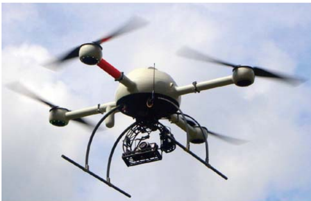
圖 1 Microdrones md4-1000 無人飛行載具
