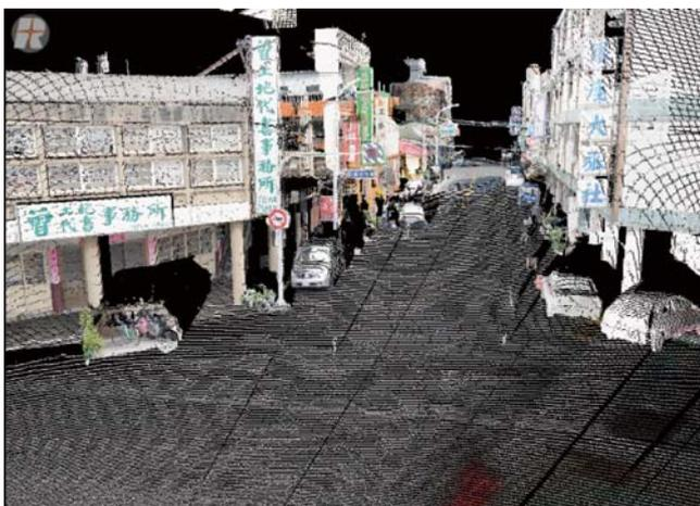
圖 4 地面光達掃描苗栗街道圖 (LinkFast Technology Co., Ltd)
