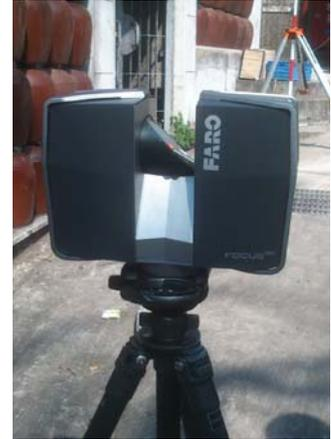
圖 11 地面雷射掃描儀 FARO FOCUS 3D
