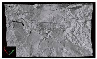
圖 14 地下坑道頂部模型
