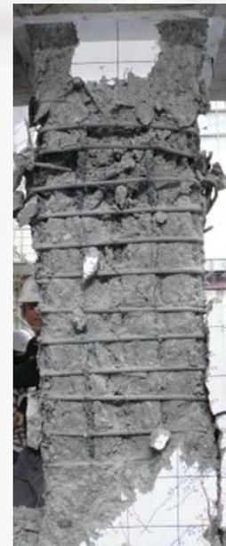
圖 9 試體 B5 之破壞圖
