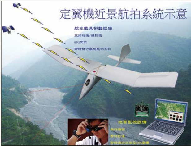
圖 4 定翼機近景航拍系統示意圖
