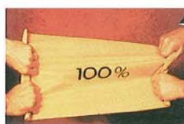
PVF皮膜拉伸測試
