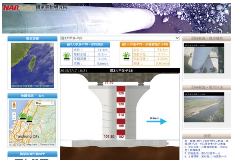
圖 4 斷橋預警 — 雲端防災互聯網系統畫面
