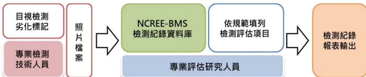
圖 3 應用 NCREE-BMS 檢測模組之資料處理程序
