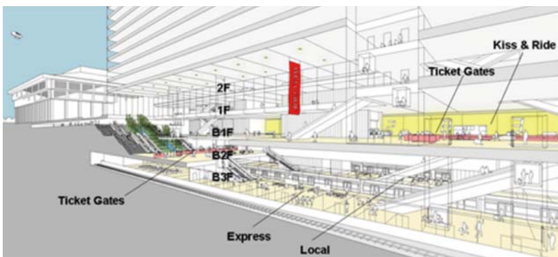
圖 11 機場捷運台北車站縱向剖面圖
