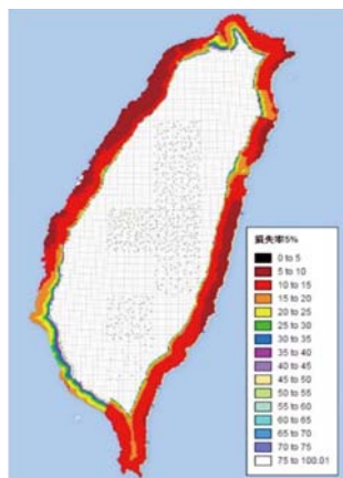
圖 5 鋼筋斷面積損失率 5% (鹽害)
