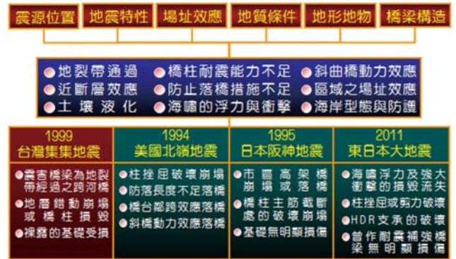
圖 11 橋梁地震災害的成因與破壞模式
