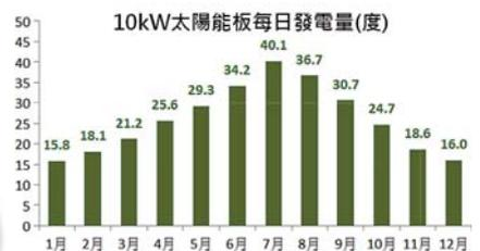
圖 10 風力發電(上)與太陽能板(下)各月份之每日發電量
