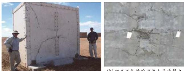
(a) ANFO 測試結果<sup>[47]</sup> (b) 超高性能纖維混凝土受衝擊之損害情形<sup>[48]</sup>
