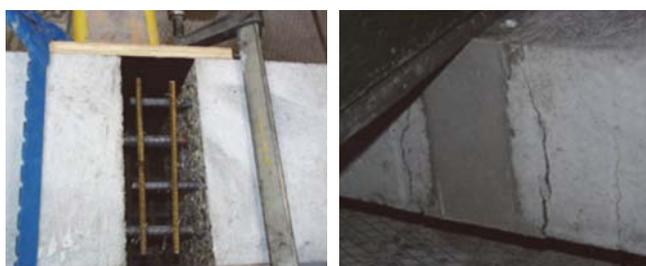
(a) 兩預鑄梁間之填充縫 (AARUP) (b) 彎曲測試破壞圖 (AARUP)
