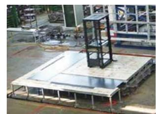
圖 17 資訊機房隔震高架地板系統試驗
