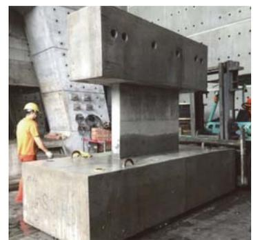
(a) 剪力牆實驗試體
