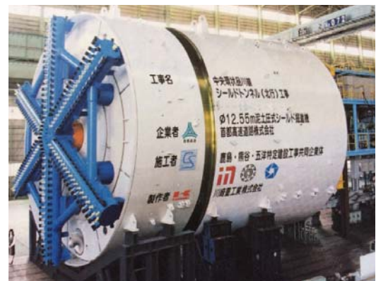
圖 13 首都高速道路中央環狀線 (品川線) φ12.55 m
