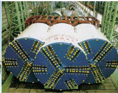
圖 18 世界首部 3 連 MF TBM 及 Osaka Business Park 車站 1996 通車
