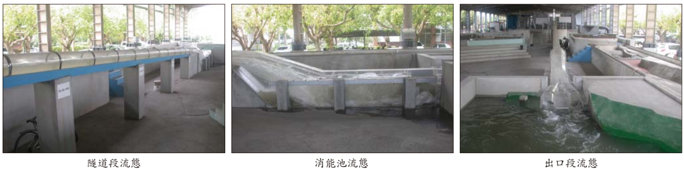
圖 5 消能池水工模型放水情況
