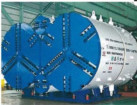
圖 19 4 心圓 TBM 施築車站
