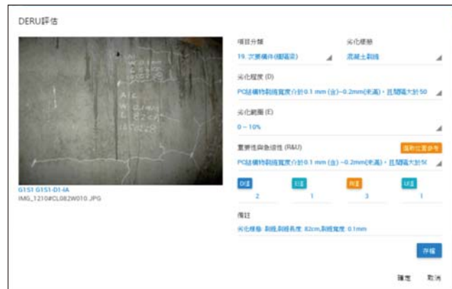
圖 10 NCREE-BMS 橋梁檢測紀錄模組畫面
